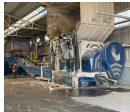
Výroba TAP – mlýn drtí a mele výmět
